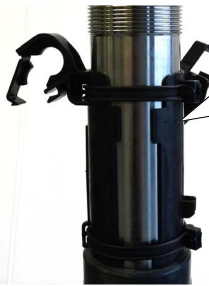
Leitungshalter vom Originalfederbein demontieren und mit Kabelbindern am gelieferten Federbein befestigen.
