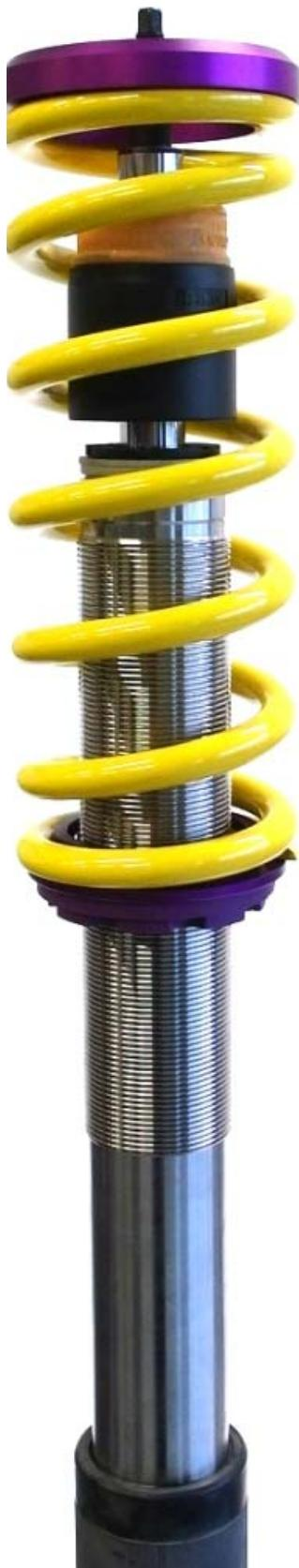
Original Stützlagereinheit ohne Kunststoffscheibe aufsetzen und mit den mitgelieferten Muttern verschrauben. Das Anzugsdrehmoment der Kolbenstangenbefestigung beträgt 20 Nm. Die Montagehinweise zum Einbau des Federbeines in das Fahrzeug, sowie die Anzugsdrehmomente der Federbeinbefestigung, entnehmen Sie bitte den Unterlagen des Fahrzeugherrstellers.
