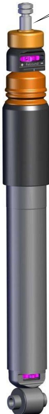
Originale Stützlagereinheit auf den Dämpfer aufsetzen und mit den mitgelieferten Muttern verschrauben. Das Anzugsdrehmoment der Kolbenstangenbefestigung beträgt 20 Nm. Die Montagehinweise zum Einbau des Federbeines in das Fahrzeug, sowie die Anzugsdrehmomente der Federbeinbefestigung, entnehmen Sie bitte den Unterlagen des Fahrzeugherstellers.
